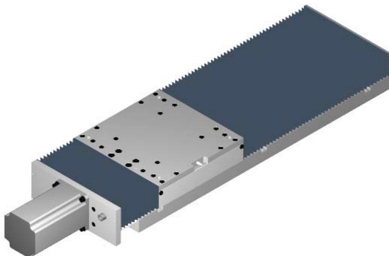
Les glissières de la gamme SGLT 235 sont des unités de déplacement rectilignes à guidage sur rails et patins qui permettent des courses d'amplitudes comprises entre 100 et 1000 mm.
